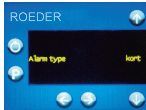
Figuur 9 Instellen alarmtype
