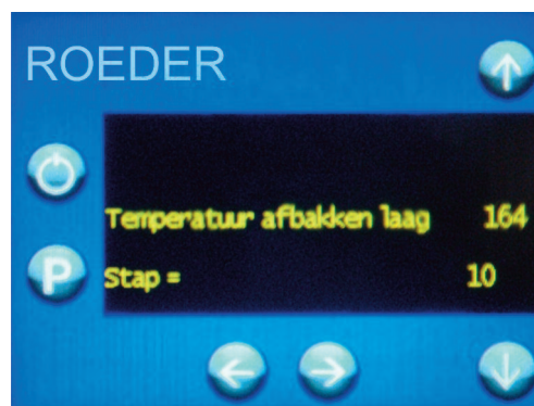
Figuur 6 Instellen temperatuur bakprogramma
